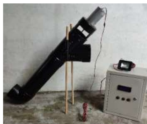
Gambar 4. Purwarupa Desain Monitoring Dan PLTPH
